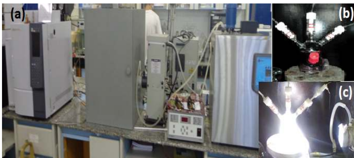
Figura 34. Sistema completo de simulador de luz solar acoplado a um CG-TCD/FID (a). Reator (b); reator sob irradiação (c).
