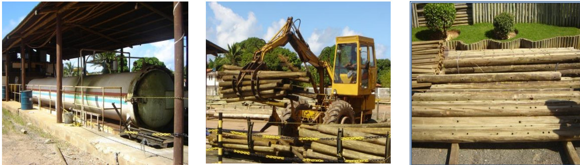
a) Tratamento sob pressão b) Movimentação com trator grua c) Secagem
