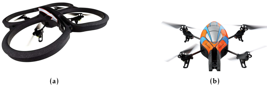
FIGURA 5.1 – Quadrirotor AR.Drone, versão 1.0, desenvolvido pela Parrot. (a) com capa para ambientes internos; (b) com capa para ambientes externos.
