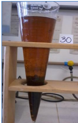
Figura 24 - Volume de lodo produzido no processo de coagulação-floculação utilizando quitosana como coagulante
