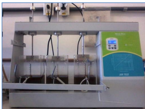
Figura 6 - Aparelho Jar test utilizado nos ensaios de coagulação-floculação
