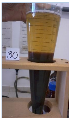
Figura 34 - Volume de lodo produzido no processo de coagulação-floculação utilizando sulfato de alumínio como coagulante
