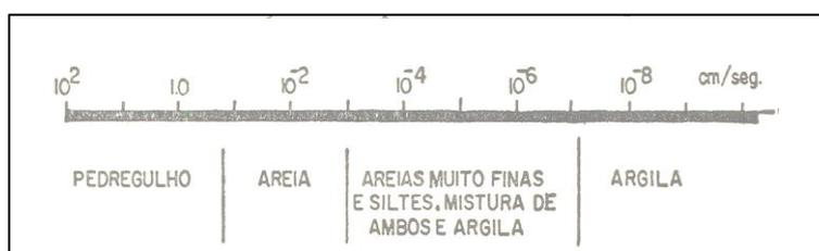
Figura 15 - Intervalos de variação dos valores de k para os diferentes tipos de solos.
