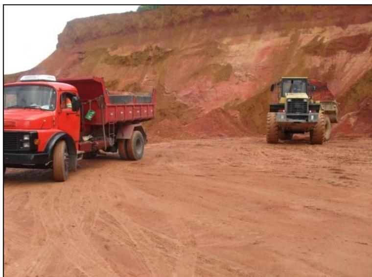
Figura 26 - Operação de decapeamento nos horizontes 1 e 2.
