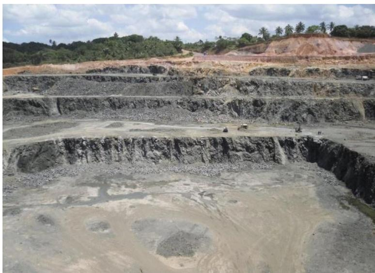
Figura 25 - Mostrando contato entre solo e rocha.
