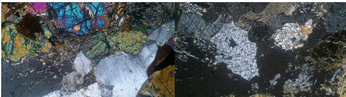
Figura 34 - Fotomicrografia do granulito básico. Notar os contatos curvos entre os grãos dos principais minerais formadores da rocha e o fraturamento.
