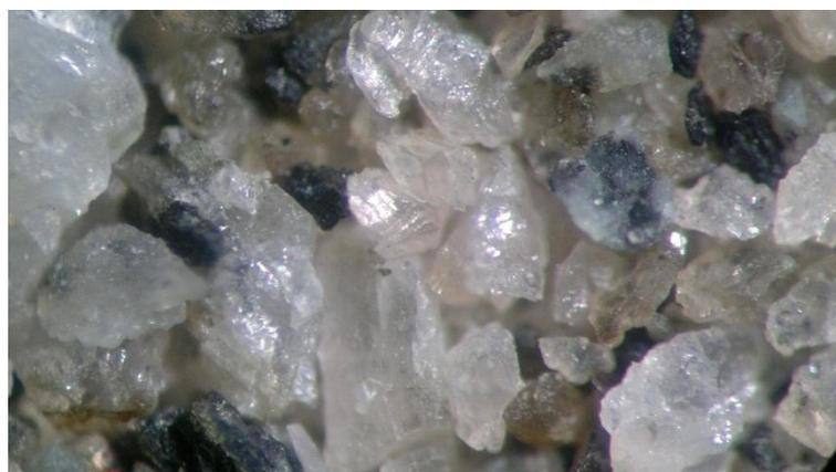
Figura 40 - Imagem obtida com a lupa binocular, da fração areia do cone. Nota a menor uniformidade da granulometria e menor grau de esfericidade dos fragmentos.
