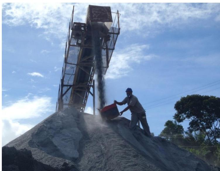
Figura 30 - Coleta de amostra da areia britada na pilha pulmão.
